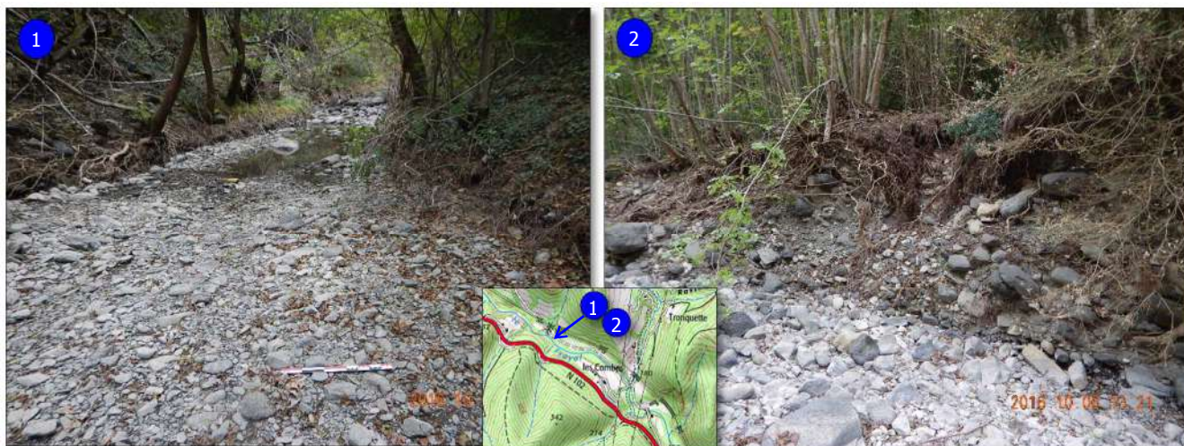
Figure 7 : (1) arbres risquant d'être arrachés à la prochaine crue ; (2) partie supérieure à dévégétaliser pour favoriser la recharge sédimentaire
