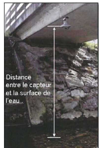
Exemple de suivi débitmétrique par capteur radar (Source : OTT Hydromet)
