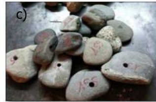
(a) Pit-tag de 23 et 19 mm, petite antenne de recherche (b) et (c) galets percés avant insertion d'un PIT-tag
