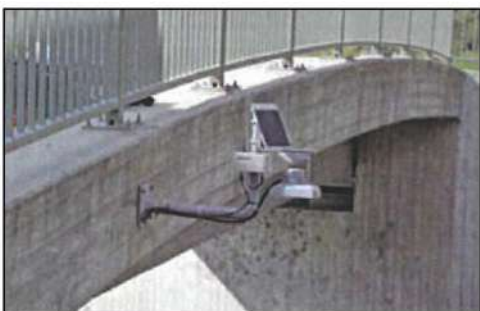
Exemple de suivi débitmétrique par capteur radar (Source : OTT Hydromet)
