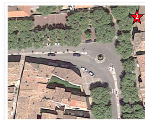
Un traitement routier du débouché de l'allée du Rhône sous la forme d'un mini giratoire, des traversées piétonnes existantes
