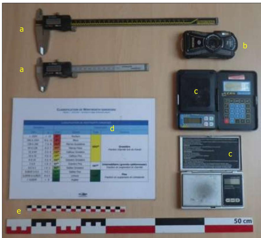
Matériel nécessaire pour les prélèvements granulométriques et le traitement : (a) pieds à coulisse numériques de 300 mm et 150 mm ; (b) appareil photographique numérique étanche pour photographier le substrat du lit ; (c) balances de différentes précisions pour les grains petits et moyens ; (d) classification granulométrique de Wentworth sandrisée (2002) ; (e) mires photographiques de 20 et 50 cm
