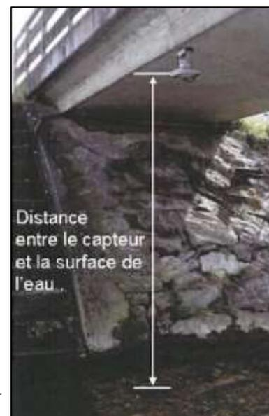
Distance entre le capteur et la surface de l'eau.
