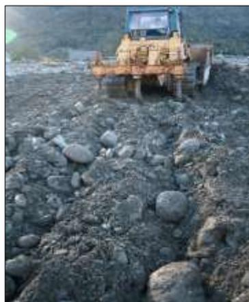
Bouteur équipé d'un ripper à 5 dents
