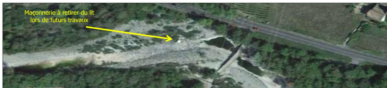
Vue générale du pont Marquet. On remarque le déport du lit en rive gauche qui passe sous la travée T1 et l'atterrissement devant les travées T2 et T3.
