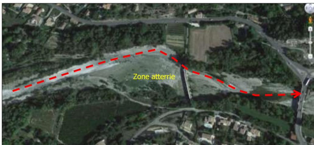
*Élargissement de la section d'écoulement au niveau du pont romain. Elle varie de 45 mètres à 130 mètres. L'axe principal de l'Escoutay est représenté en pointillés rouge.*
