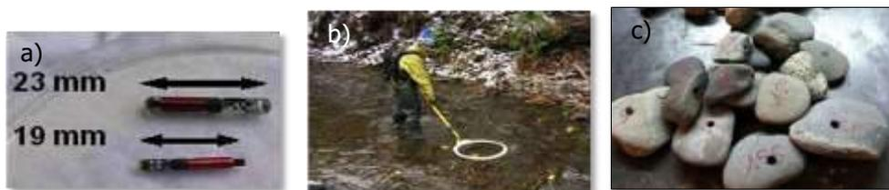
(a) Pit-tag de 23 et 19 mm, petite antenne de recherche (b) et (c) galets percés avant insertion d'un PIT-tag
