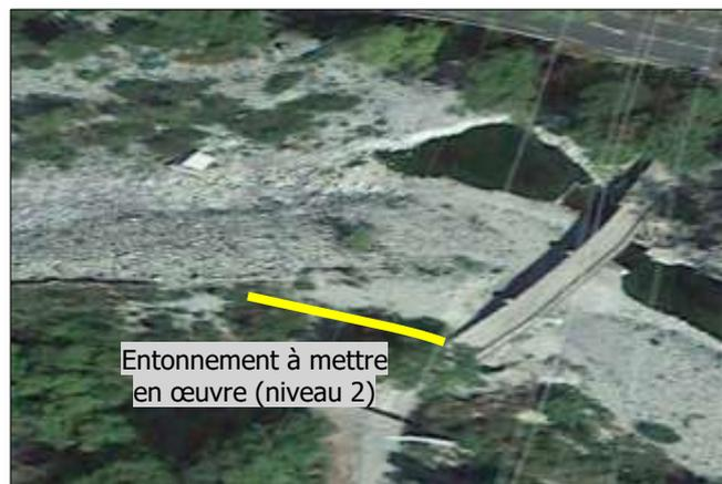
Il s'agira alors de **réaliser un confortement de berge par enrochement** correctement dimensionné (cf. annexe présentée à la fin de la fiche-action) entonnant le pont au niveau de la culée C3 et protégeant la berge.
