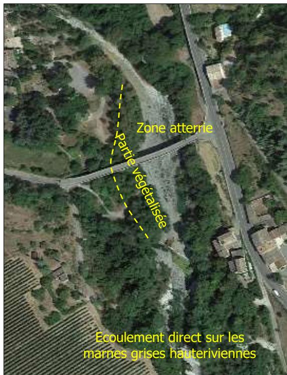
Vue aérienne montrant l'élargissement de la section au droit du pont La Roche. La section s'est partiellement refermée par végétalisation.
