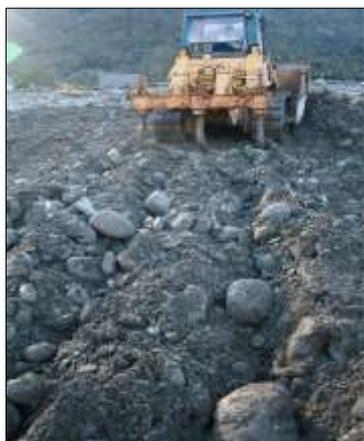
Bouteur équipé d'un ripper à 5 dents
